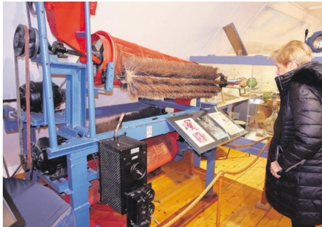
Die erste Krabbenpulmaschine, erfunden in den 1930er Jahren von Walter Preuß (Dorumer Tief), versetzt die Besucher immer noch in Staunen
