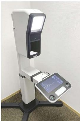
Das digitale Point-ID-System arbeitet mit einer integrierten Augenerkennung, um eine korrekte und normgerechte Aufnahme des Lichtbilds sicherzustellen. Aus diesem Grund ist es erforderlich, dass die fotografierte Person aktiv für einige Sekunden
