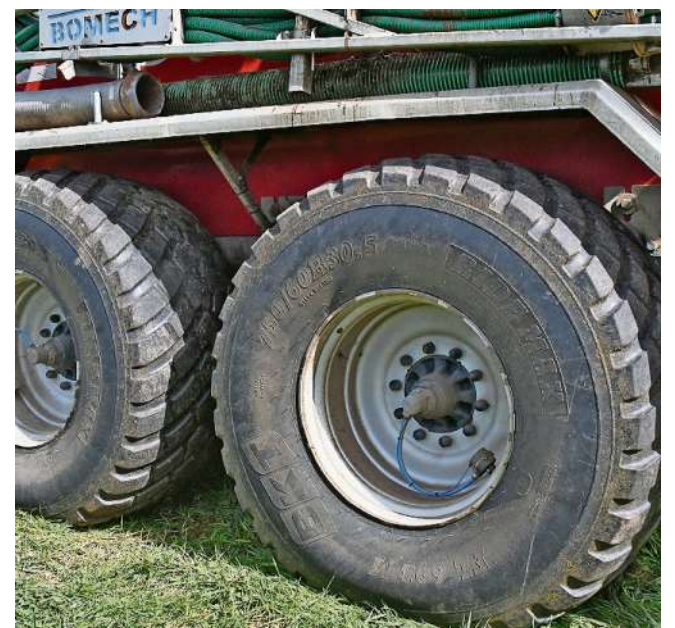
An diesem Gülleanhänger kann der Reifendruck jederzeit reguliert werden.
