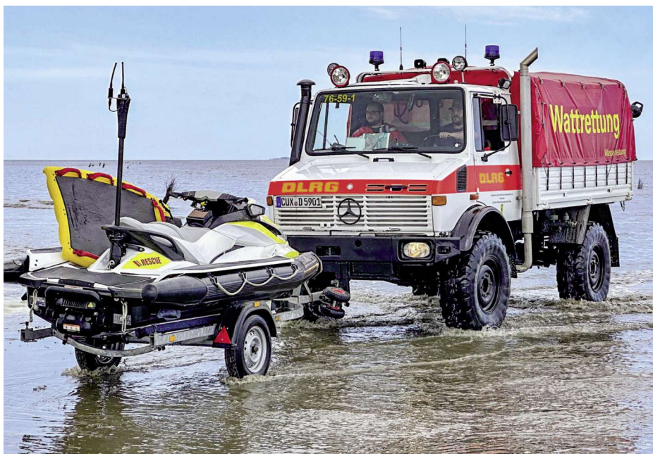
DLRG-Unimog – ausgebaut für die Wattrettung: Geländegängig mit spezieller Bereifung, GPS-Seekartenplotter, Funkgeräten, medizinischer Ausrüstung für die Erstversorgung und Trailer mit RescueJet. Foto: DLRG Cuxhaven
