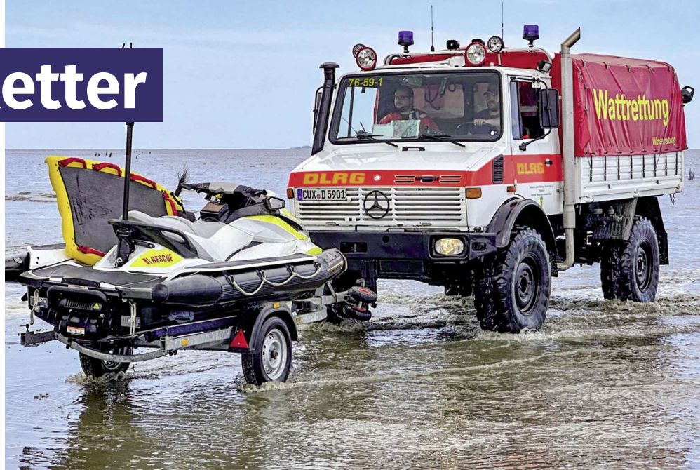
DLRG-Unimog – ausgebaut für die Wattrettung: Geländegängig mit spezieller Bereifung, GPS-Seekartenplotter, Funkgeräten, medizinischer Ausrüstung für die Erstversorgung und Trailer mit RescueJet. Fotos (3): DLRG Cuxhaven
