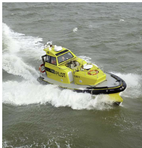
Versetzboote sind kleine, schnelle, wendige Boote, die den Schiffen entgegenfahren um den Lotsen abzusetzen oder abzuholen.
