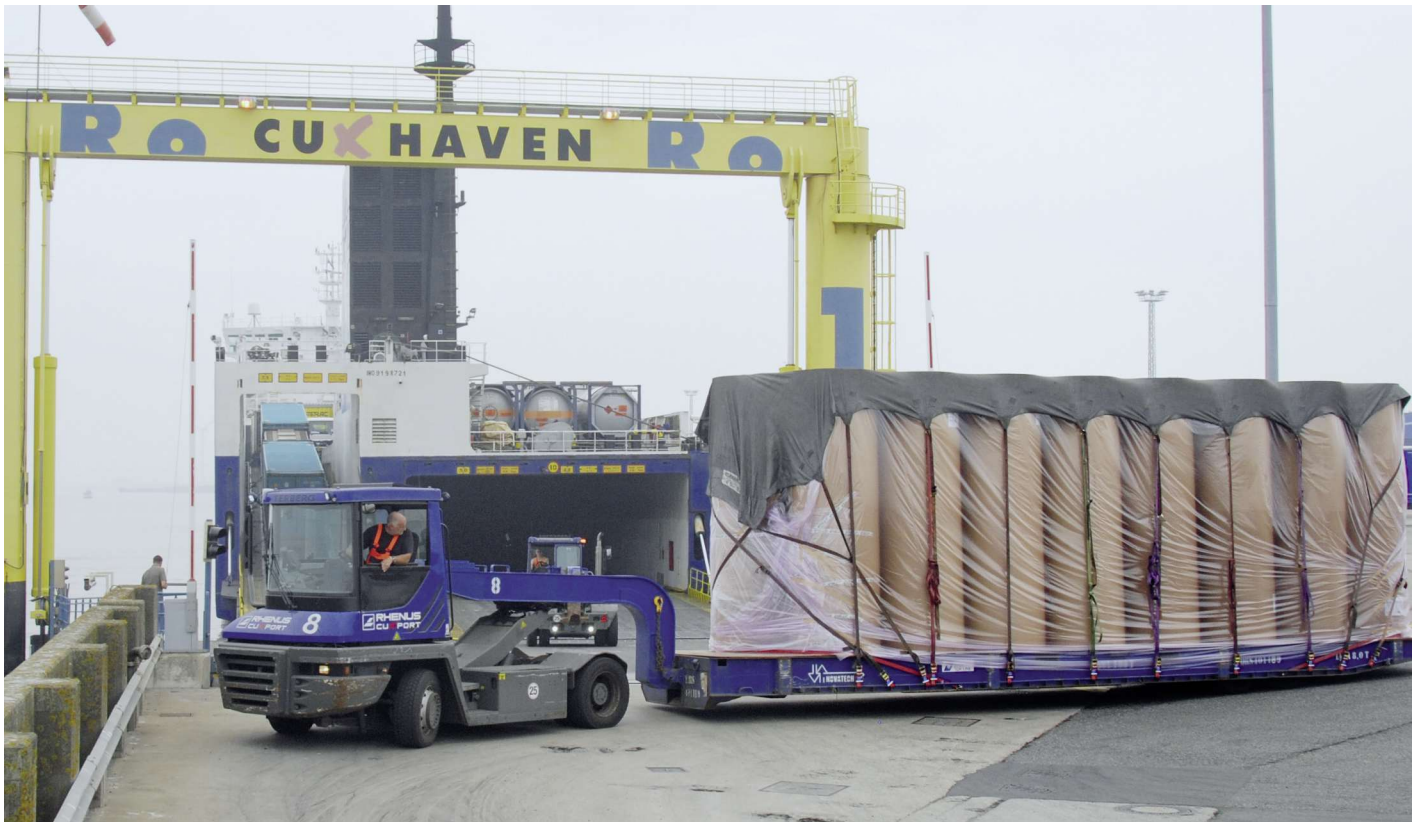
Logisticservice – mit speziellem Umschlaggerät wird die Fracht per Ro-Ro-Verfahren auf das Schiff verladen. Foto: DFDS
