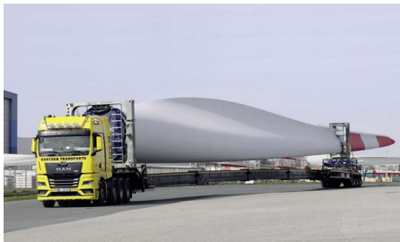
Transport von Rotorblättern mit Spezialequipment. Foto: BREB
