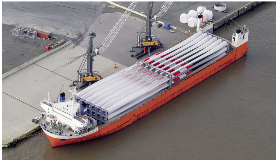
Entladen von Rotorblättern von einem speziell dafür konzipierten Deck Carrier. Foto: BREB
