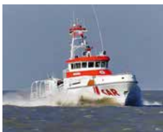
Der Seenotrettungskreuzer »Anneliese Kramer«: 28 Meter lang, 24 Knoten schnell, ca. 600 bis 800 Seemeilen Reichweite, 2 Maschinen mit zusammen fast 4.000 PS, ausgestattet mit Tochterboot und Feuerlöschmonitor (ca. 80 Meter Wurfweite).
