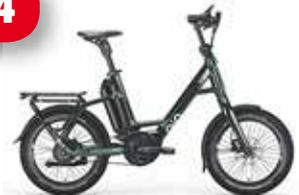
Bosch Performance Antrieb, 545 WH Akku, Stufenlos Enviolo Schaltung, Kiox Farbdisplay mit Navigation
